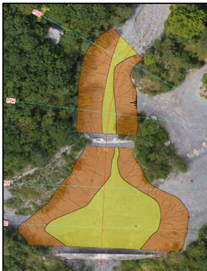
Figure 10 : Emprise des terrassements au sein de la plage de dépôt
