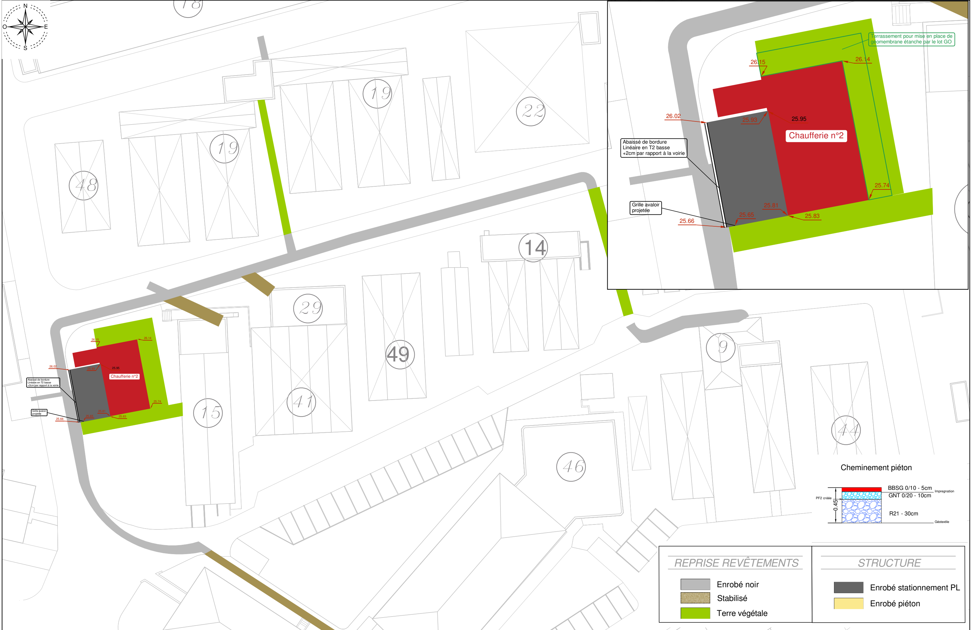
Plan des reprises de revêtements Chaufferie n°2 Plan d'ensemble
