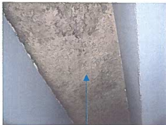
Prélèvement P17 : Flocage ne contenant pas de fibres d'amiante
