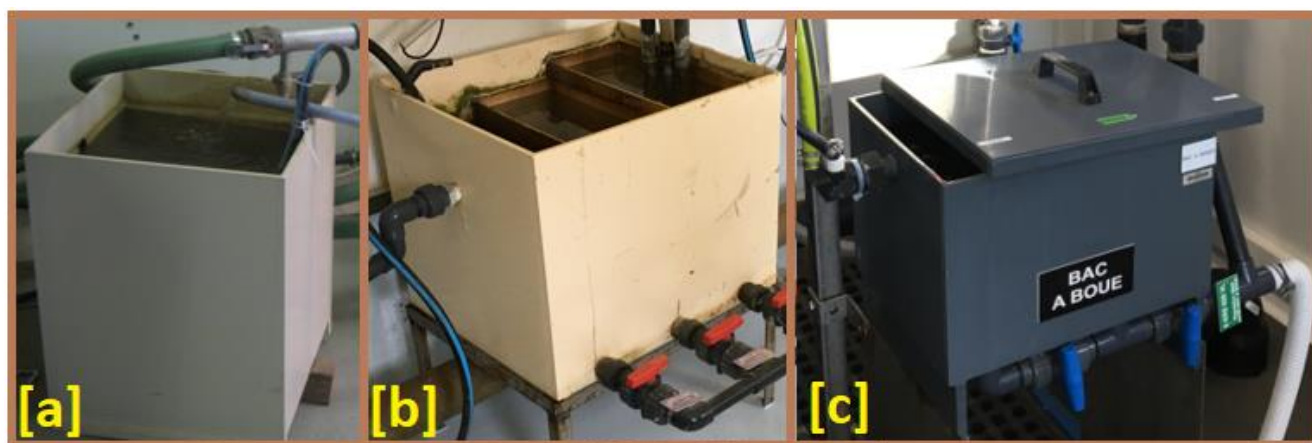
Figure 2 : systèmes de prélèvements de MES [a] SCPRI – [b] OPRI – [c] ASNR
