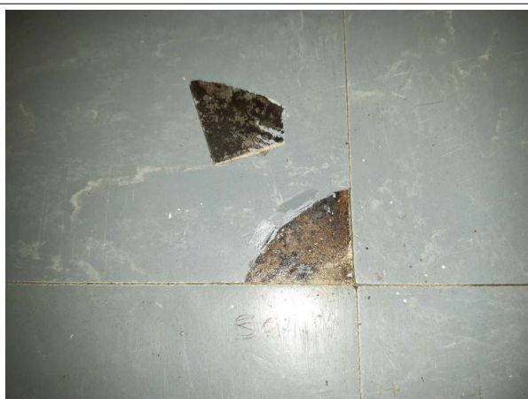
Déclaré - : ENS RENNES / R+0 / Circulation elec. - Colle- (Absence d'amiante)
