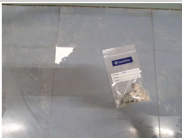
Prélèvement - P05 : ENS RENNES / R+0 / Circulation elec. - Colle, Dalle de sol- (Absence d'amiante)
