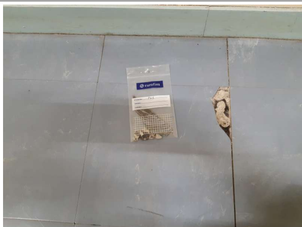
Prélèvement - P01 : ENS RENNES / R+0 / Circulation mécanique - Colle, Dalle de sol- (Absence d'amiante)
