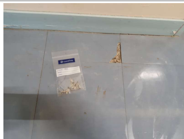
Prélèvement - P04 : ENS RENNES / R+0 / Circulation magasin - Colle, Dalle de sol- (Absence d'amiante)
