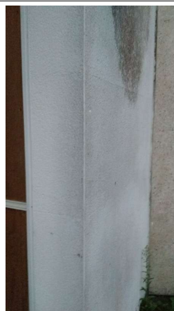
Prélèvement - P010 : R+0 / Façades rotonde - Enduit- (Absence d'amiante)
