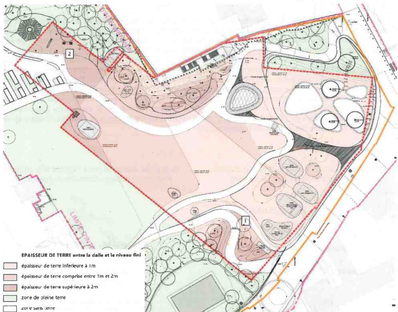
Figure 1 : Gare de Vitry centre - Epaisseur de terre sur la toiture végétalisée
