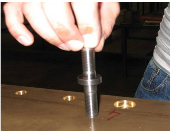
Mettez les boulons avec la plus longue partie dans les trous échelonnés de la feuille des tubes
