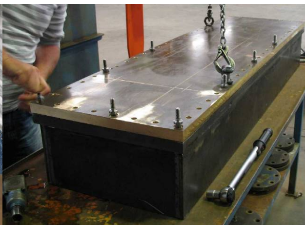
Vissez a main les boulons dans la partie inferieure de la bride de montage
