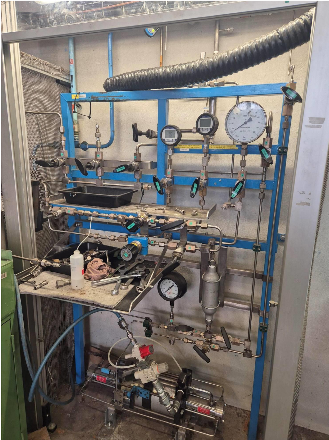
Photographie 1 : un banc de tarage de soupapes – D0001
