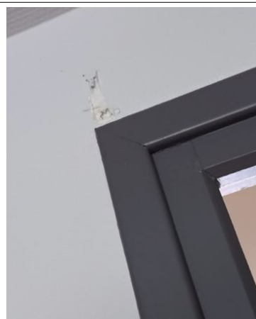
Prélèvement - P076 : OFB - POITIERS / RDC / BUREAU 3 - Bande de plaque de plâtre- (Absence d'amiante)
