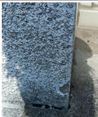
Prélèvement - P089 : OFB - POITIERS / EXTERIEUR / FACADES - Enduit- (Absence d'amiante)
