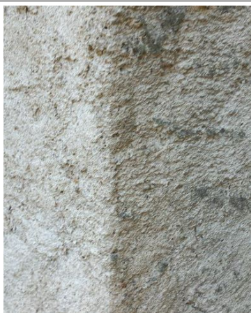
Prélèvement - P091 : OFB - POITIERS / EXTERIEUR / FACADES - Enduit- (Absence d'amiante)
