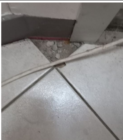
Prélèvement - P043 : OFB - POITIERS / RDC / HALL - Colle de carrelage- (Absence d'amiante)
