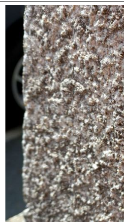
Prélèvement - P088 : OFB - POITIERS / EXTERIEUR / FACADES - Enduit- (Absence d'amiante)
