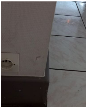
Prélèvement - P065 : OFB - POITIERS / RDC / DETENTE - Toile de verre- (Absence d'amiante)
