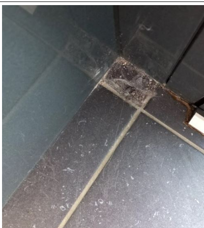
Prélèvement - P051 : OFB - POITIERS / RDC / HALL - Colle de carrelage- (Absence d'amiante)
