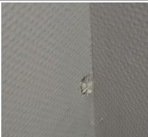
Prélèvement - P079 : OFB - POITIERS / RDC / BUREAU 5 - Bande de plaque de plâtre- (Absence d'amiante)
