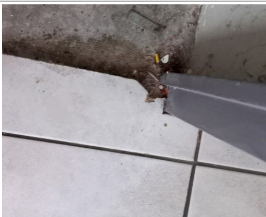
Prélèvement - P053 : OFB - POITIERS / RDC / HALL - Colle de carrelage- (Absence d'amiante)
