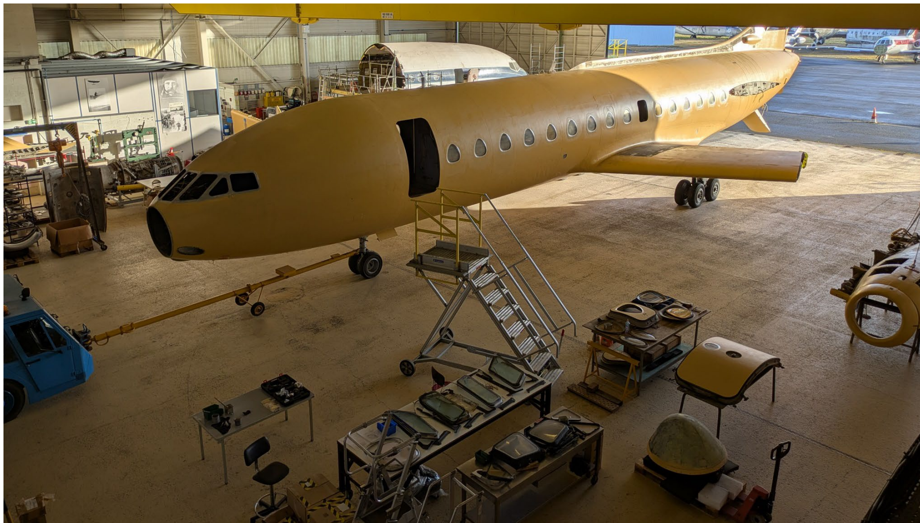
FIGURE 2 VUE GENERALE DE L'AVION DANS SON ETAT ACTUEL APRES CHANTIER D'AEROGOMMAGE ET PROTECTION TEMPORAIRE
