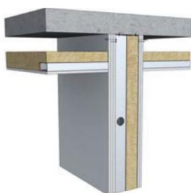
Figure 3.3.4 : Jonction entre plafond suspendu et cloison séparative légère –
