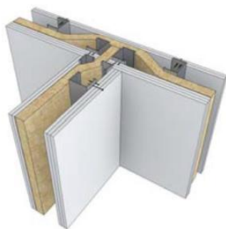
Liaison cloison / doublage
