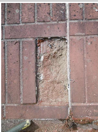
Prélèvement - P012 : CPAM / R+2 / Toiture terrasse en pente - Joint- (Absence d'amiante)
