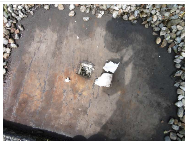
Prélèvement - P022 : CPAM / R+4 / Toitures terrasses plate - Revêtement d'étanchéité- (Absence d'amiante)
