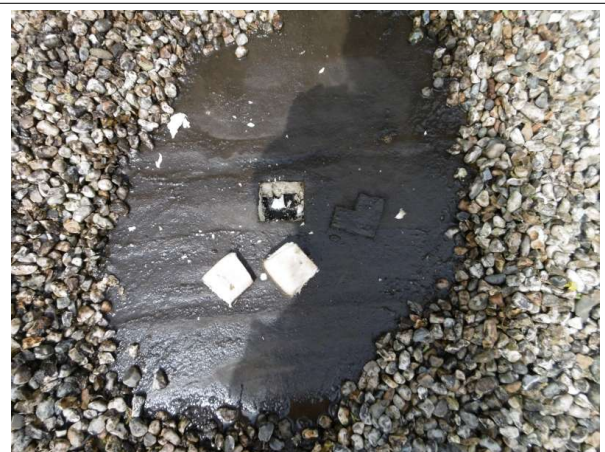
Prélèvement - P018 : CPAM / R+4 / Toitures terrasses plate - Revêtement d'étanchéité- (Absence d'amiante)
