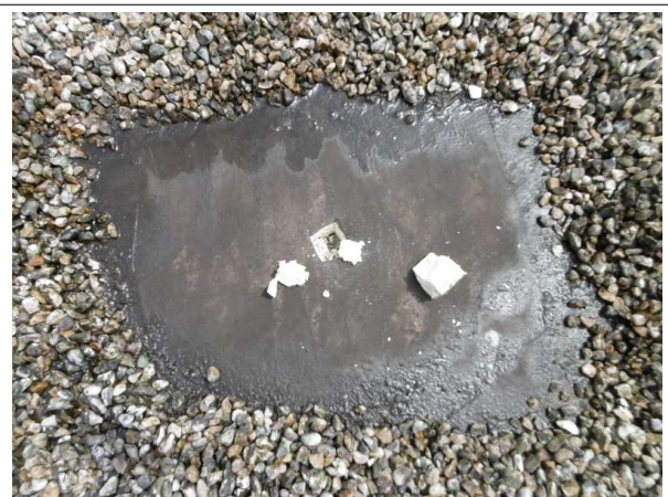
Prélèvement - P019 : CPAM / R+4 / Toitures terrasses plate - Revêtement d'étanchéité- (Absence d'amiante)
