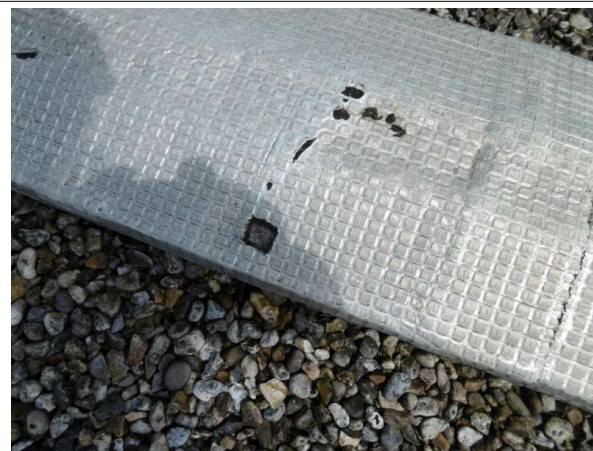
Prélèvement - P023 : CPAM / R+4 / Toitures terrasses plate - Relevé d'étanchéité- (Absence d'amiante)
