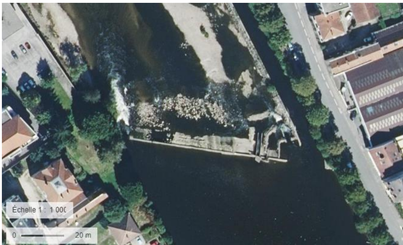
Figure 2 – Vue aérienne du seuil fixe à la suite de la rupture
