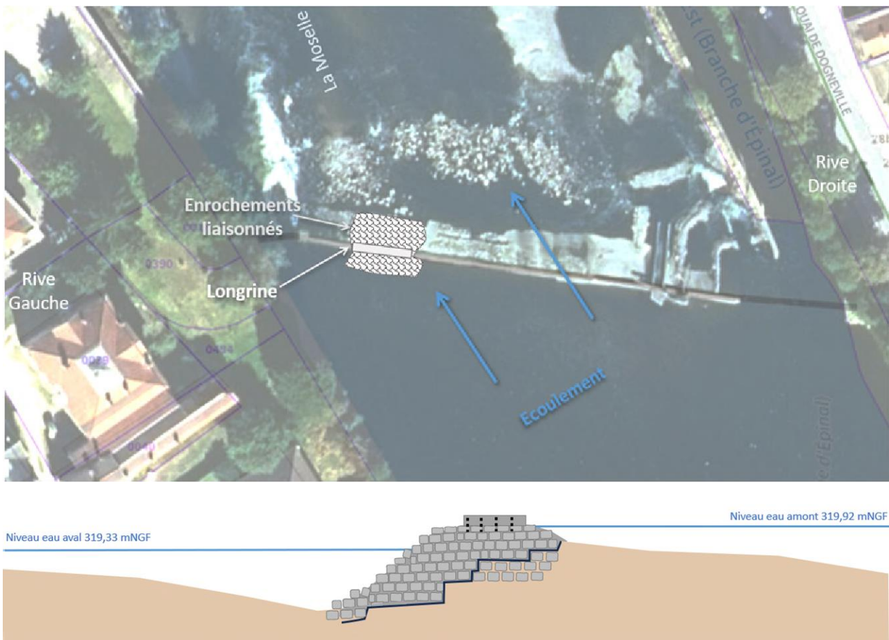
Figure 11 - Phase définitive du seuil fixe
