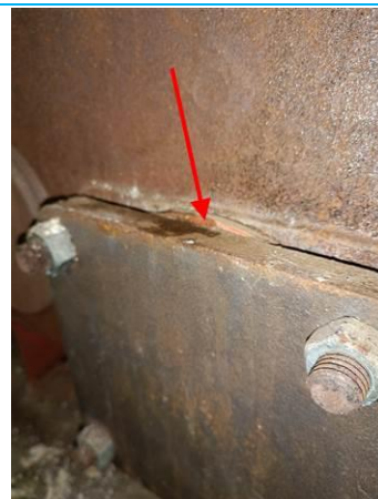
Matériaux : ZPSO-026 Prélèvement : P026 Description : Joint plat (trappe x2) Localisation : Chaudière 2; Chaudière 3 Résultat : Présence d'amiante
