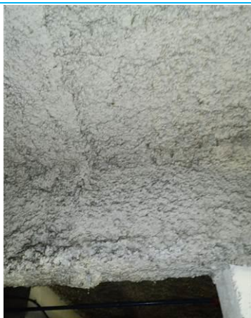
Matériaux : ZPSO-003 Prélèvement : P003 Description : Flocages Localisation : Chauffage Résultat : Absence d'amiante
