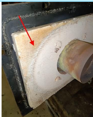
Matériaux : ZPSO-021 Prélèvement : P021 Description : Joint plat fibreux (intérieur porte) Localisation : Chaudière 2; Chaudière 3 Résultat : Absence d'amiante
