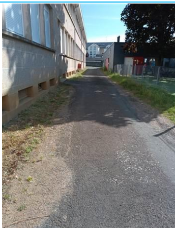
Matériaux : ZPSO-001 Prélèvement : P001 Description : Enrobé bitumineux Localisation : Extérieur bâti Résultat : Absence d'amiante
