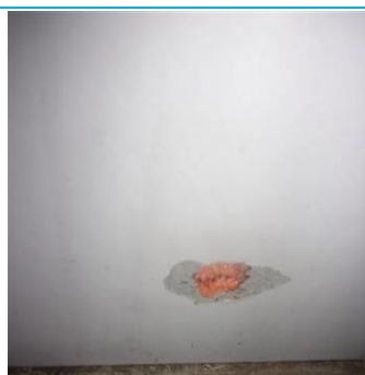
Matériaux : ZPSO-117 Prélèvement : P117 Description : Isolants sous allèges avec pare vapeur bitumineux Localisation : 3ème étage - S de TP A3.1/3; 3ème étage - TP A3.1a; 3ème étage - TP A3.5/7; 3ème étage - TP A3.7a; 3ème étage - A3.12; 3ème étage - A3.10; 3ème étage - A3.8; 3ème étage - A3.4; 3ème étage - A3.2 Résultat : Présence d'amiante
