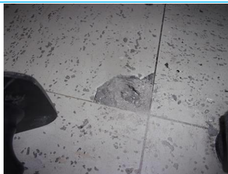
Matériaux : ZPSO-024 Prélèvement : P024 Description : Colle de carrelage ragréage sous dalles de sol Localisation : 10ème étage - C10.a 9 Résultat : Absence d'amiante
