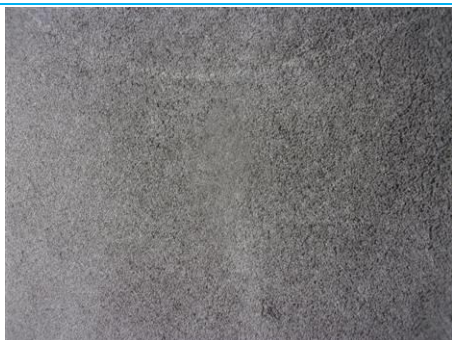
Matériaux : ZPSO-079 Prélèvement : P079 Description : Enduit peinture façade Localisation : 4ème étage - Façades Résultat : Absence d'amiante
