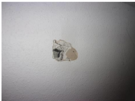
Matériaux : ZPSO-015 Prélèvement : P015 Description : Enduit peinture mur et doublage Localisation : 10 ème étage - BUREAU B10.18 BUR; 10 ème étage - TE B10.7c LTE Résultat : Présence d'amiante
