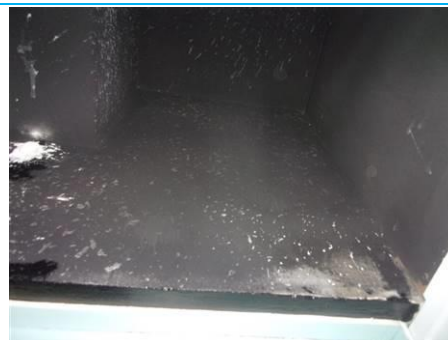
Matériaux : ZPSO-166 Prélèvement : P173 Description : Enduit peinture plafond Localisation : 9ème étage - Couloir Résultat : Absence d'amiante
