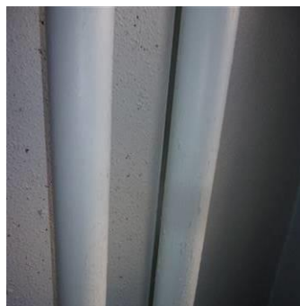
Matériaux : ZPSO-145 Prélèvement : P145 Description : Peinture conduit Localisation : 2ème étage - C2. 1; 2ème étage - C2. 2; 2ème étage - C2. 15 Résultat : Absence d'amiante
