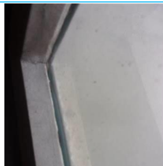
Matériaux : ZPSO-083 Prélèvement : P083 Description : Mastic vitrier Localisation : 5ème étage - A5 SAS CIR Résultat : Présence d'amiante
