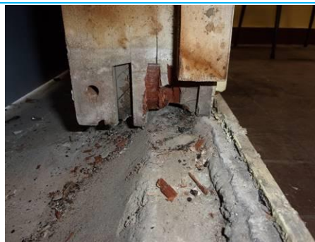
Matériaux : ZPSO-154 Prélèvement : P160 Description : Joint de menuiserie Localisation : 6ème étage - C2VN 1 LAB A6.7 Résultat : Absence d'amiante
