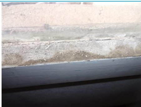
Matériaux : ZPSO-041 Prélèvement : P041 Description : Mastic vitrier Localisation : 9ème étage - C9 SAS CIR Résultat : Présence d'amiante
