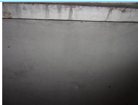
Matériaux : ZPSO-116 Prélèvement : P116 Description : Allège Localisation : 2ème étage - B2 SAS CIR Résultat : Absence d'amiante
