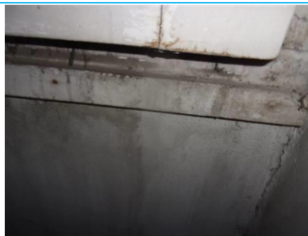
Matériaux : ZPSO-002 Prélèvement : P002 Description : allège Enduit peinture Localisation : 10 ème étage - A10 SAS CIR Résultat : Absence d'amiante
