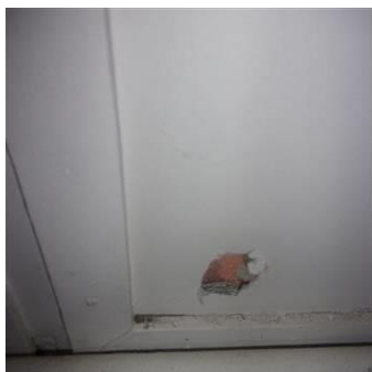
Matériaux : ZPSO-088 Prélèvement : P088 Description : Isolants sous allèges Localisation : 5ème étage - A5.6 Résultat : Absence d'amiante
