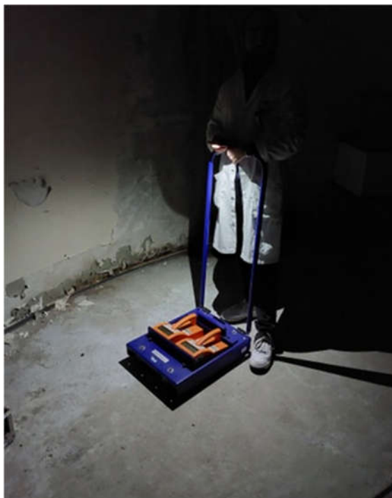
Contrôles de contamination par mesure directe (contaminamètres 2x300cm 2 sur chariot)
