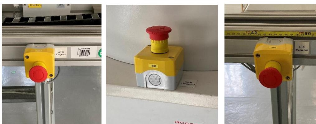
Figure 11 : Boutons d'arrêt d'urgence de l'irradiateur photons
