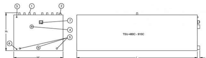
1. Connexions de la batterie ; 2. Apport d'eau DN50 ; 3. Trop-plein DN50 ; 4. Sortie d'eau ; 5. Entrée d'eau ; 6. Vidange DN50 ; 7. ICE LOGIC®.
