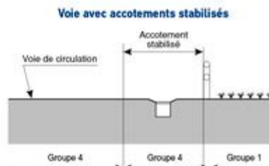
Fig. B - Détail type d'un accotement stabilisé représentant quelques groupes de lieux d'installation.
