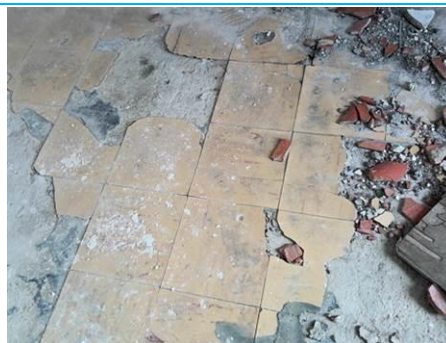
Matériaux : ZPSO-002 Prélèvement : P002 Description : Dalle de sol Localisation : Local 1 Résultat : Présence d'amiante
