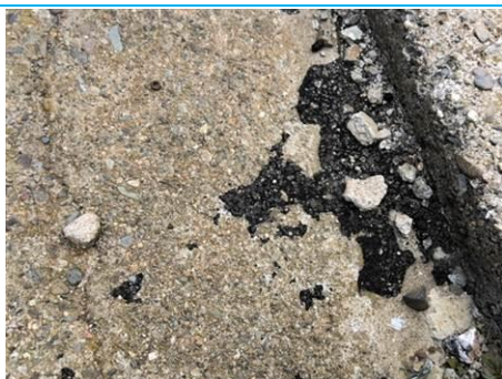
Matériaux : ZPSO-003 Prélèvement : P005 Description : Colle bitumineuse Localisation : Rez de chaussée - Local 1 Résultat : Absence d'amiante
