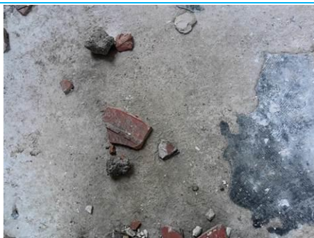
Matériaux : ZPSO-001 Prélèvement : P001 Description : Colle non bitumineuse Localisation : Local 1 Résultat : Présence d'amiante
