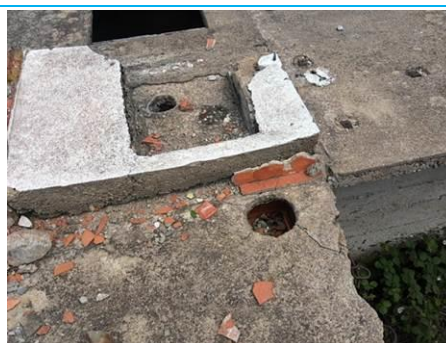
Matériaux : ZPSO-004 Prélèvement : P004 Description : Enduit à base de ciment lissé ou taloché Localisation : Local 1 Résultat : Absence d'amiante
