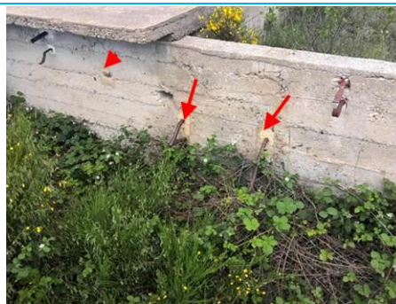
Matériaux : ZPSO-002 Prélèvement : P002 Description : Enduit de scellement Localisation : Local 1; Local 2 Résultat : Absence d'amiante
