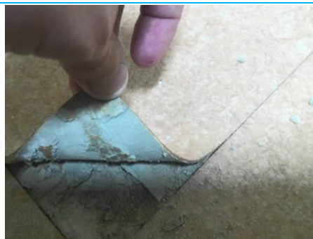
Matériaux : ZPSO-182 Prélèvement : P206 Description : Ragréage Localisation : 2ème étage - Ch. 19 Résultat : Absence d'amiante
