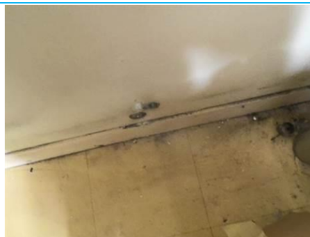
Matériaux : ZPSO-074 Prélèvement : P074 Description : Béton + peinture Localisation : 1er étage - Rgt 4 Résultat : Absence d'amiante
