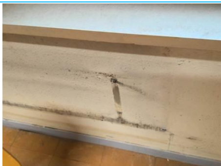
Matériaux : ZPSO-025 Prélèvement : P025 Description : Béton + peinture Localisation : 1er étage - D-207 Résultat : Absence d'amiante
