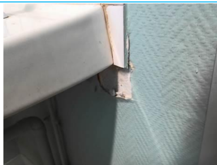
Matériaux : ZPSO-085 Prélèvement : P086 Description : Colle de faïence Localisation : 1er étage - Rgt D-210 Résultat : Absence d'amiante
