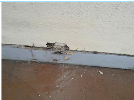
Matériaux : ZPSO-013 Prélèvement : P013 Description : Béton + peinture Localisation : 1er étage - D-203 Résultat : Absence d'amiante
