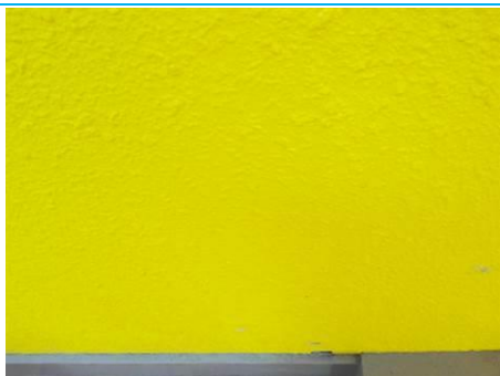
Matériaux : ZPSO-108 Prélèvement : P115 Description : Béton + peinture Localisation : 2ème étage - Palier 2 Résultat : Absence d'amiante
