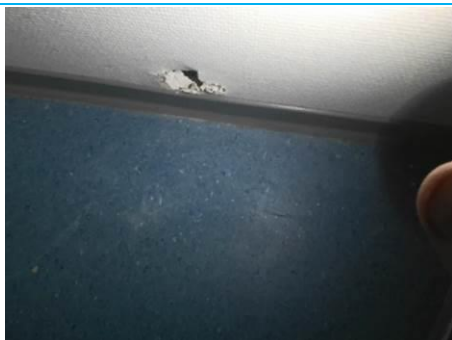
Matériaux : ZPSO-118 Prélèvement : P139 Description : Cloison placo plâtre Localisation : 2ème étage - Bains 3 Résultat : Absence d'amiante
