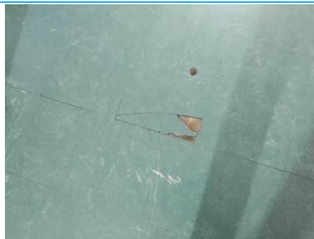
Matériaux : ZPSO-087 Prélèvement : P090 Description : Dalle de sol bleue + colle noir Localisation : 1er étage - Dgt 4 Résultat : Présence d'amiante
