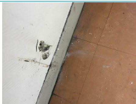
Matériaux : ZPSO-068 Prélèvement : P068 Description : Béton + peinture Localisation : 1er étage - D-214 Résultat : Absence d'amiante
