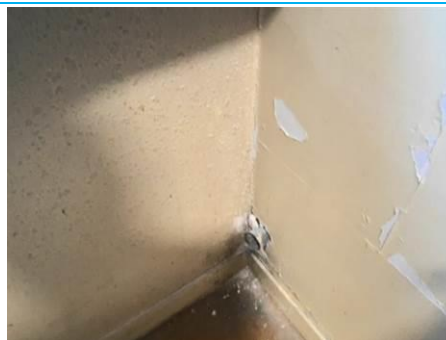
Matériaux : ZPSO-028 Prélèvement : P028 Description : Béton + peinture Localisation : 1er étage - Rgt D-207 Résultat : Absence d'amiante
