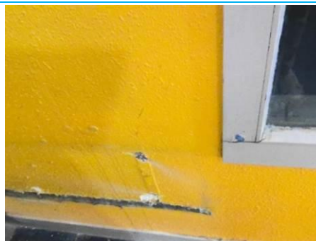
Matériaux : ZPSO-099 Prélèvement : P106 Description : Béton + peinture Localisation : 1er étage - Escalier 1 Résultat : Absence d'amiante
