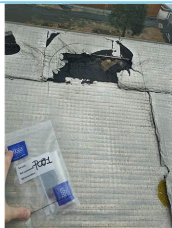
Matériaux : ZPSO-199 Prélèvement : P224 Description : Relevé : revêtement bitumineux (bandes, lés...) Localisation : Bâtiment D - Toiture Résultat : Absence d'amiante
