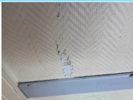
Matériaux : ZPSO-003 Prélèvement : P003 Description : cloison plâtre Localisation : 1er étage - D-201 Résultat : Absence d'amiante
