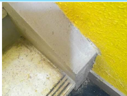
Matériaux : ZPSO-138 Prélèvement : P160 Description : Béton + peinture Localisation : Rez de chaussée - Cage d'escalier 2 Résultat : Absence d'amiante
