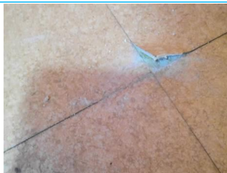
Matériaux : ZPSO-188 Prélèvement : P212 Description : Ragréage + colle Localisation : 2ème étage - Palier 4 Résultat : Absence d'amiante
