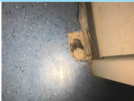
Matériaux : ZPSO-122 Prélèvement : P143 Description : dalle de sol Localisation : 2ème étage - Bains 3 Résultat : Absence d'amiante
