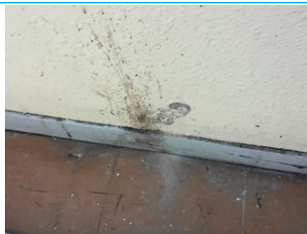
Matériaux : ZPSO-002 Prélèvement : P002 Description : Béton + peinture Localisation : 1er étage - D-201 Résultat : Absence d'amiante
