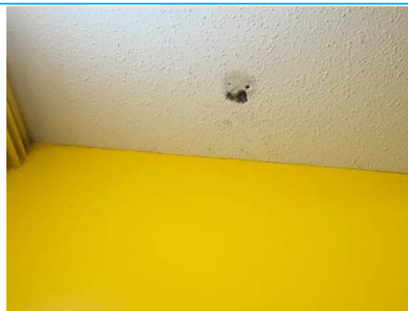
Matériaux : ZPSO-136 Prélèvement : P158 Description : Enduit à base de plâtre lissé ou taloché Localisation : Rez de chaussée - Cage d'escalier 2 Résultat : Absence d'amiante
