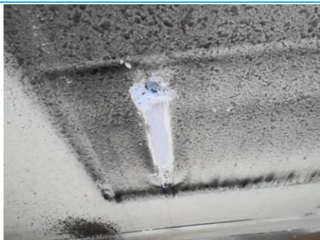
Matériaux : ZPSO-041 Prélèvement : P041 Description : Béton + peinture Localisation : 1er étage - Rgt D-209 Résultat : Absence d'amiante
