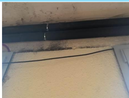
Matériaux : ZPSO-010 Prélèvement : P010 Description : Béton + peinture Localisation : 1er étage - D-202 Résultat : Absence d'amiante
