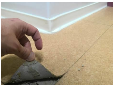
Matériaux : ZPSO-181 Prélèvement : P205 Description : Colle jaune lino Localisation : 2ème étage - Ch. 19 Résultat : Absence d'amiante
