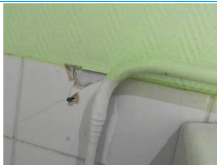
Matériaux : ZPSO-086 Prélèvement : P088 Description : Colle de faïence Localisation : 1er étage - Sanitaires F Résultat : Absence d'amiante
