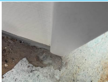
Matériaux : ZPSO-123 Prélèvement : P130 Description : dalle béton Localisation : 2ème étage - Bains 7 Résultat : Absence d'amiante
