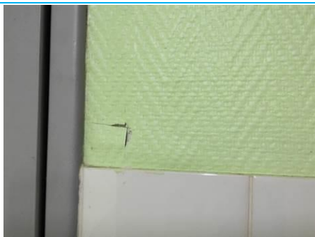
Matériaux : ZPSO-055 Prélèvement : P055 Description : Cloison plâtre Localisation : 1er étage - Sanitaires F Résultat : Absence d'amiante
