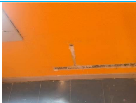
Matériaux : ZPSO-134 Prélèvement : P156 Description : Béton + peinture Localisation : Rez de chaussée - Cage d'escalier 1 Résultat : Absence d'amiante
