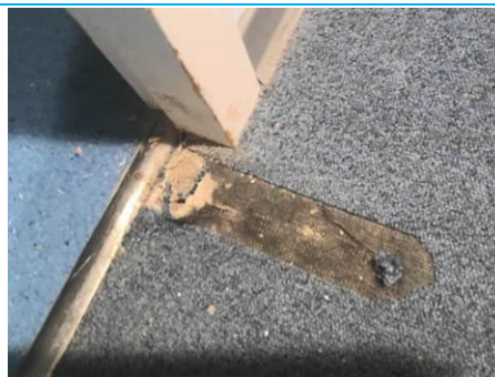
Matériaux : ZPSO-125 Prélèvement : P146 Description : Ragraéage + colle Localisation : 2ème étage - Ch. 7 Résultat : Absence d'amiante
