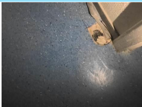
Matériaux : ZPSO-120 Prélèvement : P141 Description : Colle jaune moquette Localisation : 2ème étage - Bains 3 Résultat : Absence d'amiante
