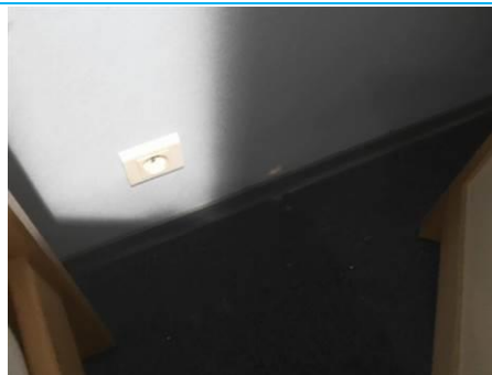
Matériaux : ZPSO-129 Prélèvement : P150 Description : Cloison plâtre Localisation : 2ème étage - Ch. 3 Résultat : Absence d'amiante
