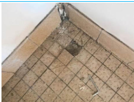
Matériaux : ZPSO-173 Prélèvement : P197 Description : Joint de carrelage Localisation : 2ème étage - Sanitaires Résultat : Absence d'amiante
