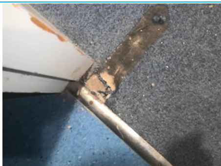
Matériaux : ZPSO-124 Prélèvement : P145 Description : Ragraéage Localisation : 2ème étage - Ch. 3 Résultat : Absence d'amiante
