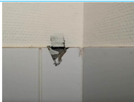
Matériaux : ZPSO-130 Prélèvement : P152 Description : Colle de faïence Localisation : 2ème étage - Sanitaires F Résultat : Absence d'amiante
