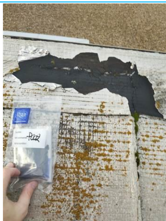
Matériaux : ZPSO-199 Prélèvement : P225 Description : Relevé : revêtement bitumineux (bandes, lés...) Localisation : Bâtiment D - Toiture Résultat : Absence d'amiante
