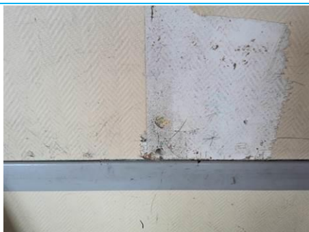
Matériaux : ZPSO-017 Prélèvement : P017 Description : Cloison plâtre Localisation : 1er étage - D-204 Résultat : Absence d'amiante
