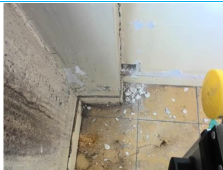
Matériaux : ZPSO-006 Prélèvement : P006 Description : Cloison plâtre Localisation : 1er étage - Rgt D-201 Résultat : Absence d'amiante
