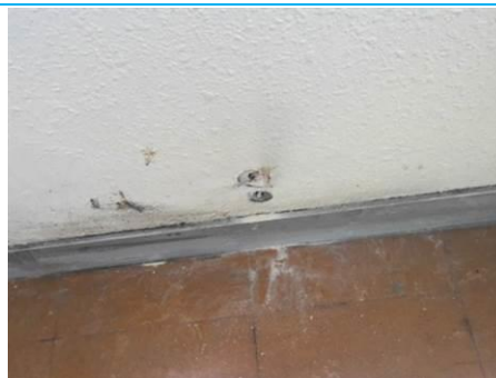
Matériaux : ZPSO-050 Prélèvement : P050 Description : Béton + peinture Localisation : 1er étage - D-211 Résultat : Absence d'amiante
