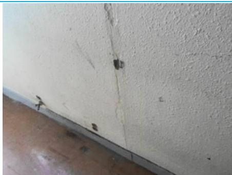
Matériaux : ZPSO-047 Prélèvement : P047 Description : Béton + peinture Localisation : 1er étage - D-210 Résultat : Absence d'amiante
