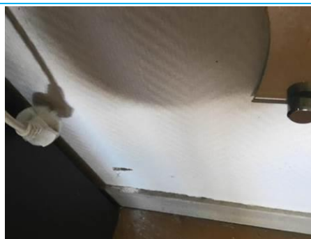
Matériaux : ZPSO-072 Prélèvement : P072 Description : Cloison plâtre Localisation : 1er étage - Rgt D-214 Résultat : Absence d'amiante
