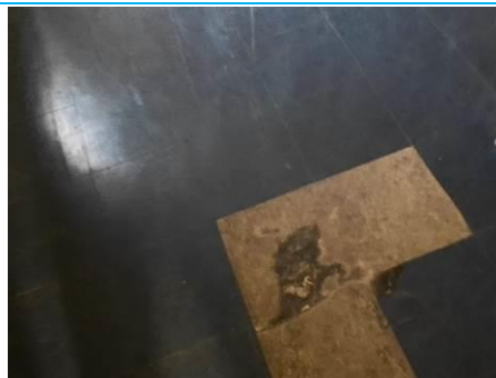
Matériaux : ZPSO-090 Prélèvement : P096 Description : Dalle de sol Localisation : 1er étage - Escalier 3 Résultat : Présence d'amiante
