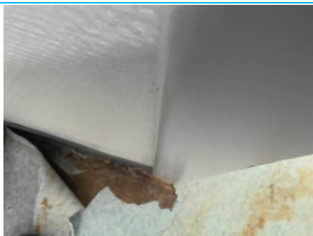
Matériaux : ZPSO-120 Prélèvement : P127 Description : Colle jaune lino Localisation : 2ème étage - Bains 7 Résultat : Absence d'amiante
