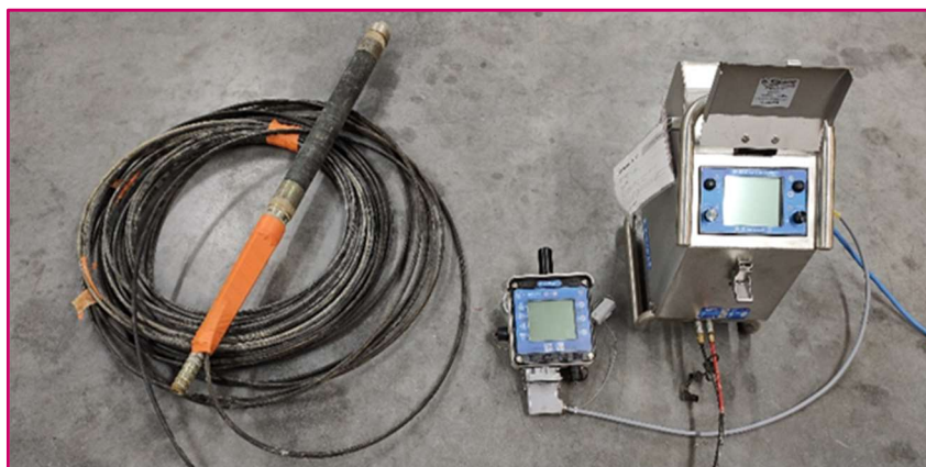
Sonde pressiométrique + Tubulure avec BAP 160 et PREVO 100 (de gauche à droite)
