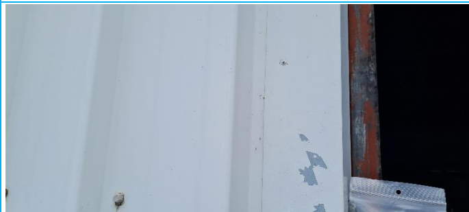
Matériaux : 05P Description : Peinture (blanche) Localisation : Façades (tôles) Résultat : Concentration massique en plomb acido-soluble <1.5mg/g
