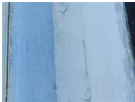
Matériaux : ZPSO-081 Prélèvement : P091 Description : Enduit extérieur + peinture (blanc) Localisation : Façade 004 Résultat : Absence d'amiante
