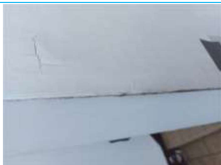
Matériaux : ZPSO-044 Prélèvement : P071 Description : Enduit à base de plâtre lissé + peinture (blanc) Localisation : Rdc - Hangar Résultat : Absence d'amiante
