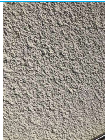
Matériaux : ZPSO-021 Prélèvement : 47 Description : Peinture bleu/beige/Enduit Localisation : BAT17/RDC - Parties extérieures Résultat : Absence d'amiante
