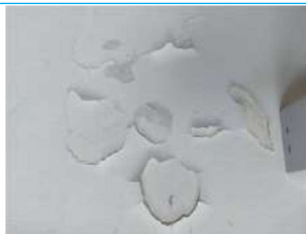
Matériaux : ZPSO-039 Prélèvement : P060 Description : Peinture (blanc) Localisation : R+1 - 015 Résultat : Absence d'amiante
