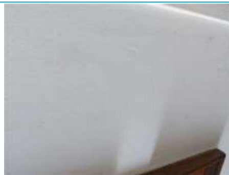
Matériaux : ZPSO-044 Prélèvement : P080 Description : Enduit à base de plâtre lissé + peinture (blanc) Localisation : Rdc - 009 Résultat : Absence d'amiante
