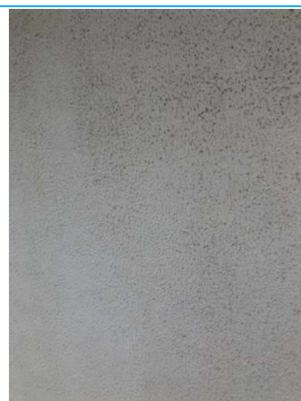
Matériaux : ZPSO-021 Prélèvement : 35 Description : Peinture blanche/Enduit Localisation : BAT14/RDC - Parties extérieures Résultat : Absence d'amiante
