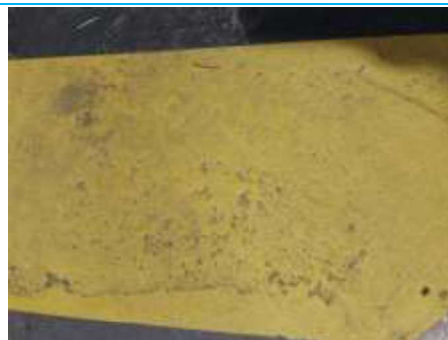
Matériaux : ZPSO-078 Prélèvement : P086 Description : Ragréage + peinture (jaune) Localisation : Rdc - Hangar Résultat : Absence d'amiante
