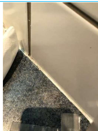
Matériaux : ZPSO-013 Prélèvement : 24 Description : Joint blanc Localisation : BAT14/RDC - 013 Résultat : Absence d'amiante
