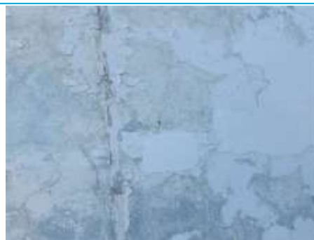
Matériaux : ZPSO-083 Prélèvement : P096 Description : Peinture (blanc) Localisation : Façade 007 Résultat : Absence d'amiante
