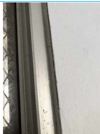
Matériaux : ZPSO-005 Prélèvement : 06 Description : Joint de menuiserie gris Localisation : BAT17/RDC - 001 Résultat : Absence d'amiante
