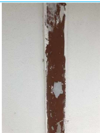
Matériaux : ZPSO-023 Prélèvement : 42 Description : Peinture blanche/Enduit lisse Localisation : BAT14/RDC - Parties extérieures Résultat : Absence d'amiante
