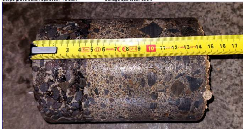
Chape grave béton épaisseur 4 à 5cm
