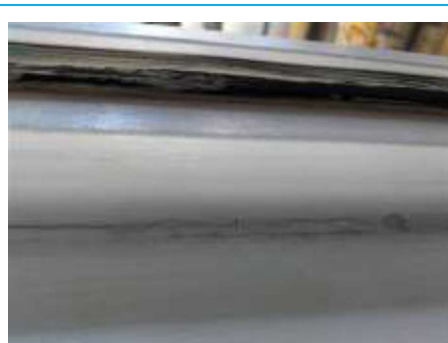
Matériaux : ZPSO-007 Prélèvement : P010 Description : Joint d'étanchéité entre menuiserie et structure Localisation : R+1 - 003 Résultat : Absence d'amiante
