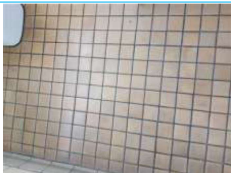
Matériaux : ZPSO-020 Prélèvement : P031 Description : Colle de carrelage 5x5 (marron) Localisation : R+1 - 011 Résultat : Absence d'amiante
