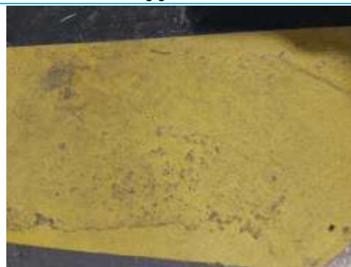
Matériaux : 12P Description : Peinture (jaune) Localisation : Rdc – Hangar Résultat : Concentration massique en plomb acido-soluble >1.5mg/g
