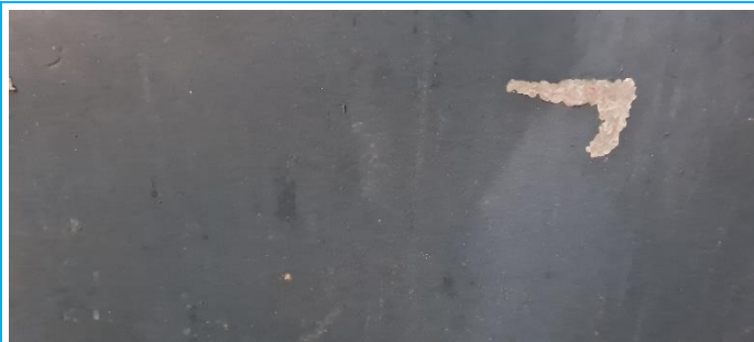
Matériaux : 01P Description : Peinture (bleue) Localisation : RDC (ossatures métalliques) Résultat : Concentration massique en plomb acido-soluble <1.5mg/g
