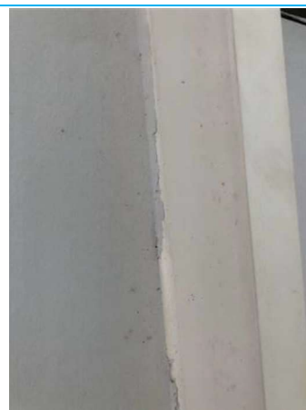
Matériaux : ZPSO-006 Prélèvement : 07 Description : Joint de menuiserie blanc Localisation : BAT17/RDC - 001 Résultat : Absence d'amiante
