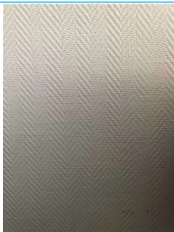
Matériaux : ZPSO-011 Prélèvement : 18 Description : Papier blanc motif/Enduit Localisation : BAT14/RDC - 004 Résultat : Absence d'amiante
