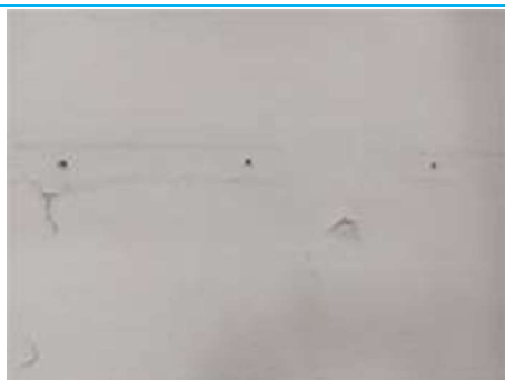
Matériaux : ZPSO-075 Prélèvement : P083 Description : Peinture (blanc) Localisation : Rdc - Hangar Résultat : Absence d'amiante
