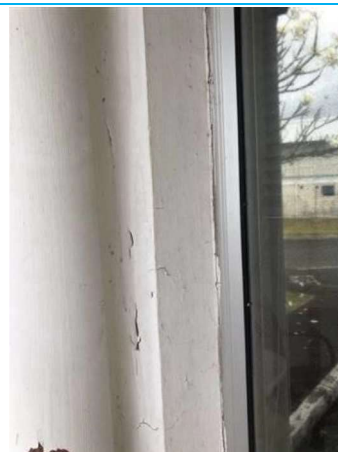
Matériaux : ZPSO-023 Prélèvement : 39 Description : Peinture blanche/Enduit lisse Localisation : BAT14/RDC - Parties extérieures Résultat : Absence d'amiante
