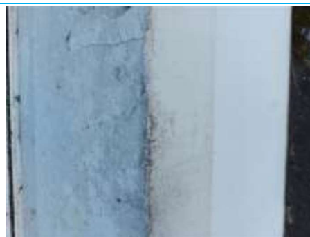
Matériaux : ZPSO-081 Prélèvement : P094 Description : Enduit extérieur + peinture (blanc) Localisation : Façade 008 Résultat : Absence d'amiante
