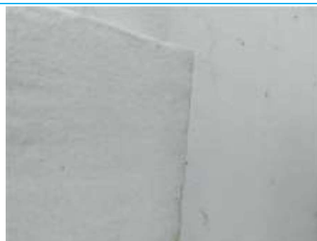
Matériaux : ZPSO-081 Prélèvement : P100 Description : Enduit extérieur + peinture (blanc) Localisation : Façade 010 Résultat : Présence d'amiante
