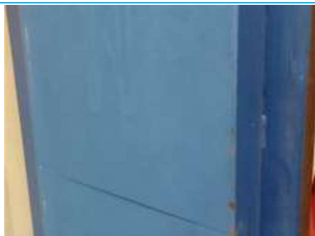
Matériaux : ZPSO-077 Prélèvement : P085 Description : Peinture (bleu) Localisation : Rdc - Hangar Résultat : Absence d'amiante
