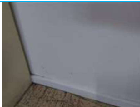
Matériaux : ZPSO-065 Prélèvement : P122 Description : Enduit à base de plâtre lissé + peinture (blanc) Localisation : Rdc - 017 Résultat : Absence d'amiante
