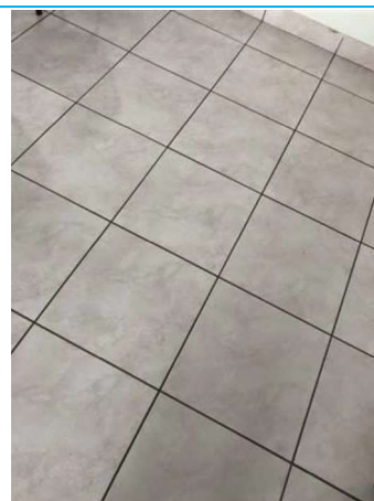
Matériaux : ZPSO-015 Prélèvement : 25 Description : Carrelage 60x60 beige/Colle de carrelage Localisation : BAT14/RDC - 017 Résultat : Absence d'amiante
