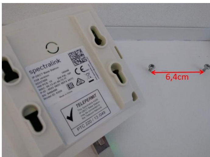
Vue arrière d'une borne avec vis de fixation au mur en arrière-plan
