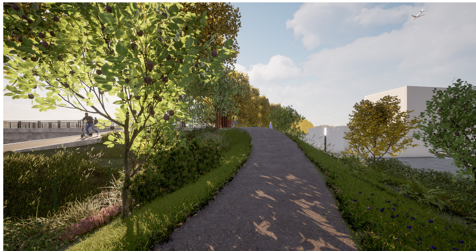
Modélisation de la rampe en remblai, tracé curviligne de la voie cycle pour adoucir les talus latéraux - Pièce AVP
