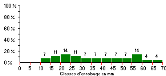
Fig. 30 : Statistique d'enrobage réalisée en sous-face et en retombée de la poutre parallèle au couloir
