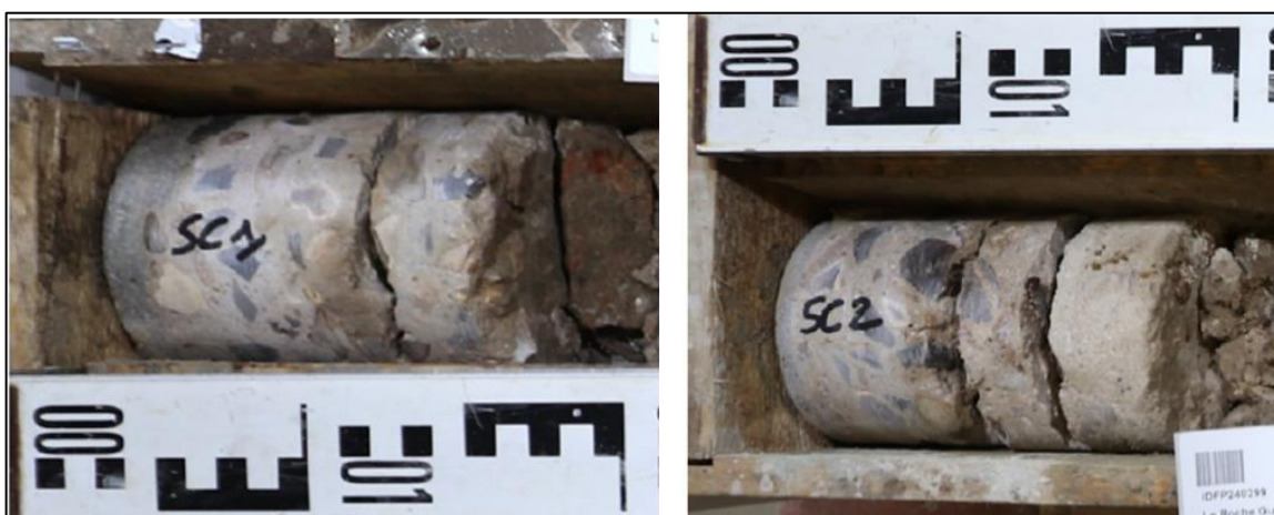
Photo 1 : Structure de voirie observée au droit des sondages SC1 et SC2
