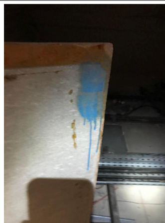
Prélèvement - P4 : R+1 / PLENUM - Plaque - EP- (Présence d'amiante)
