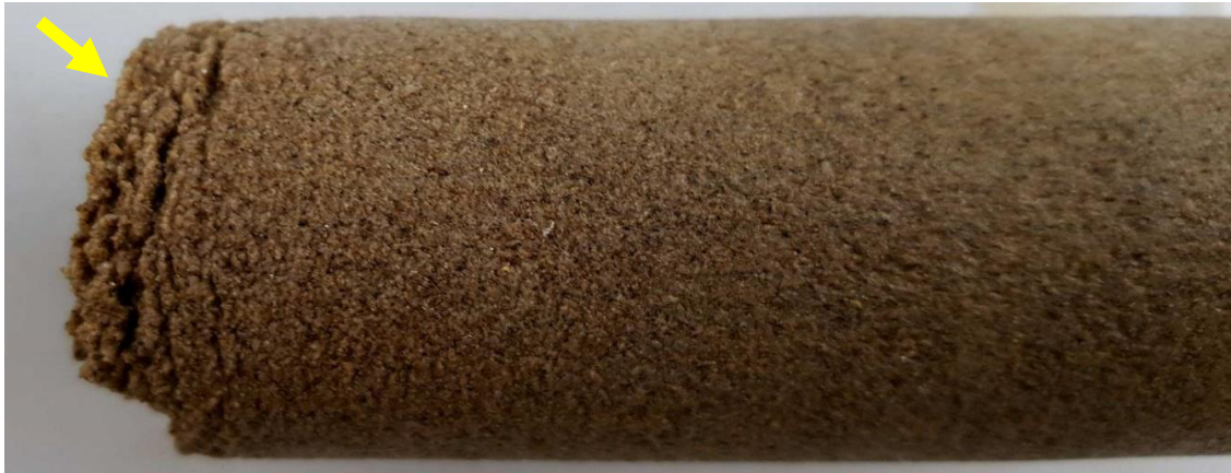
Détail du délitement à la surface de la carotte P3
