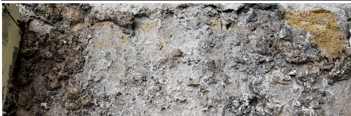
HR3/S3 : prélèvement sur molasse gréseuse dans frange d'altération – h=320 mm
