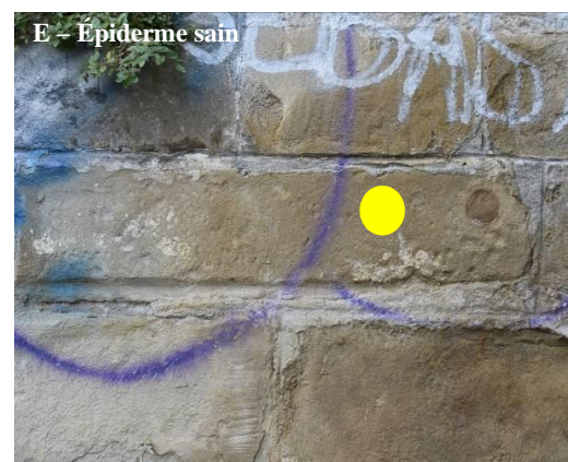
Localisation des différents points d'application de la pipe de Karsten sur le parement en molasse
