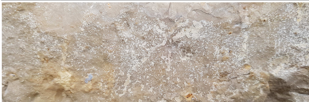
HR2/S2 : prélèvement sur pierre blanche en corniche du mur de soutènement – h=450 mm
