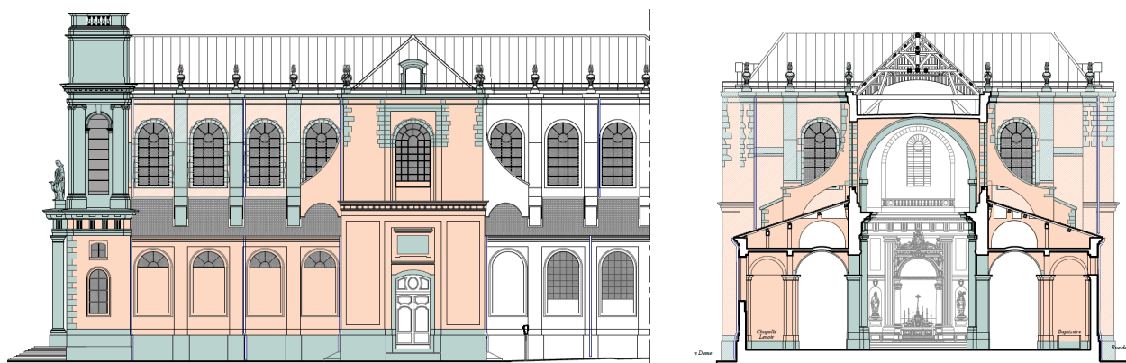
Analyse des matériaux de construction de la cathédrale : en bleu la pierre, en rose la brique. Façade sud et coupe transversale. Dessins ©Agence Caillaault
