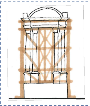
Schéma de principe pour l'étaieement des retables :
