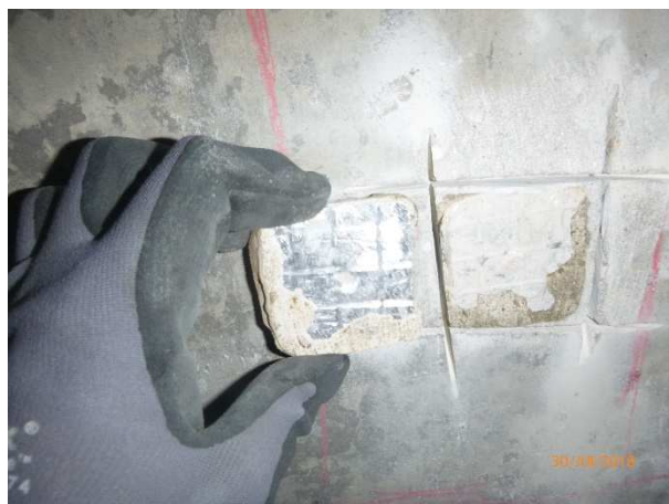
Essai n°9 : Après arrachement
