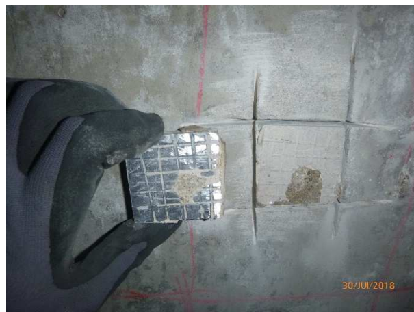
Essai n°10 : Après arrachement
