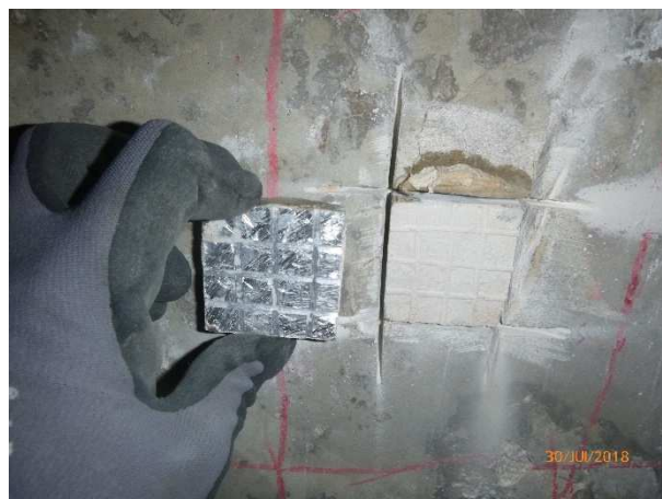
Essai n°11 : Après arrachement
