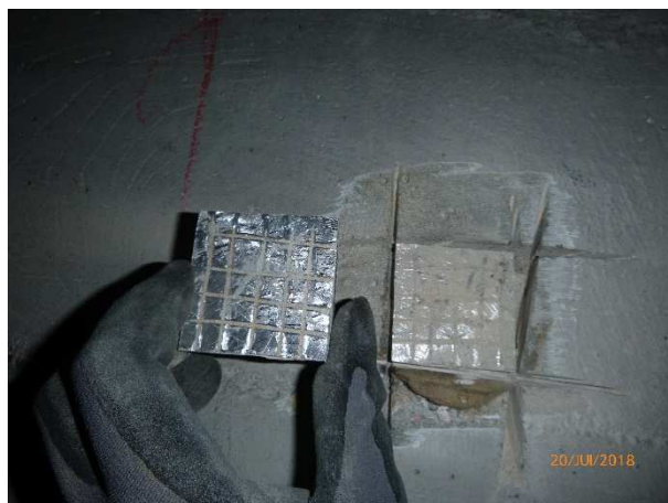
Essai n°8 : Après arrachement
