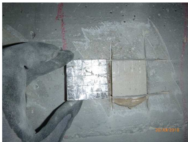
Essai n°5 : Après arrachement
