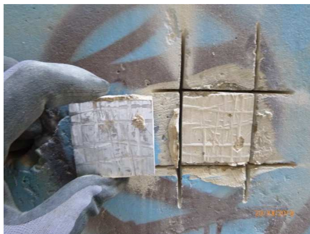
Essai n°2 : Après arrachement
