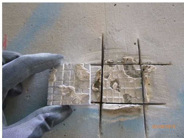
Essai n°4 : Après arrachement
