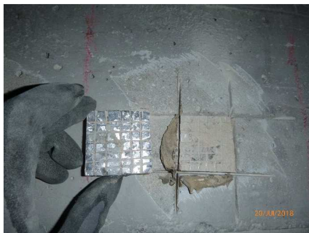
Essai n°6 : Après arrachement
