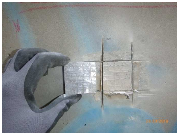
Essai n°3 : Après arrachement
