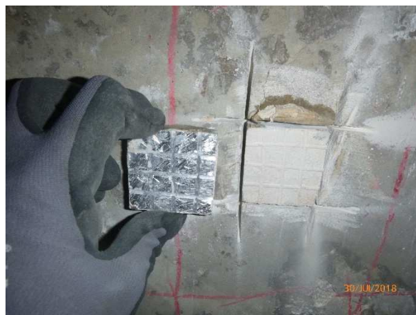
Essai n°12 : Après arrachement
