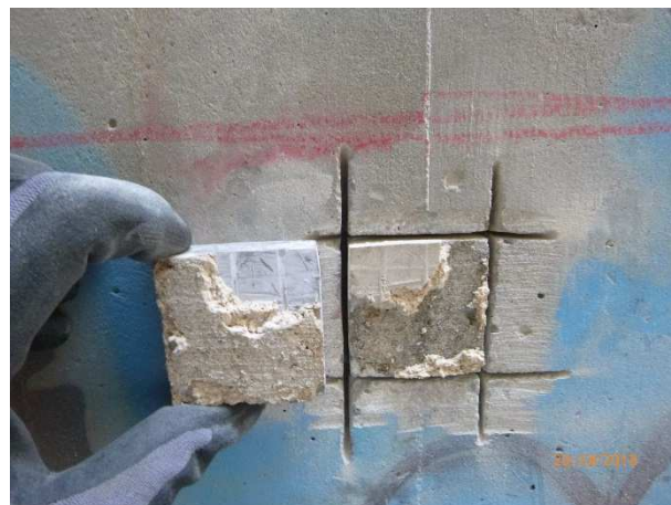
Essai n°1 : Après arrachement
