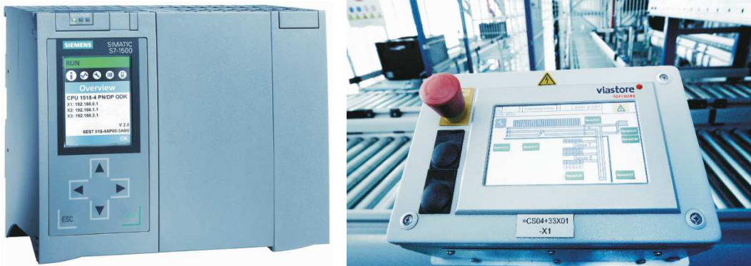
Fig. : Terminal tactile local manuel S7-1500 et stationnaire utilisé
