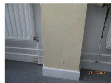
Prélèvement - P026 : R+3/Bât B / Bureau 304 - Enduit- (Absence d'amiante)
