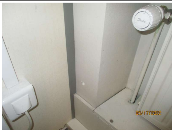
Prélèvement - P001 : R+1/Bât A / Chef DSPL - Enduit- (Absence d'amiante)
