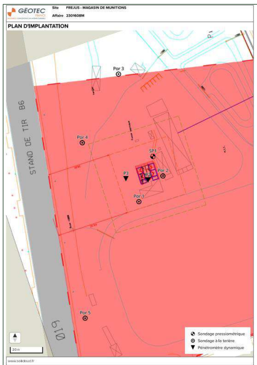
Figure 5-2 : Localisation des sondages pressiométriques, à la tarière et au pénétromètre dynamique
