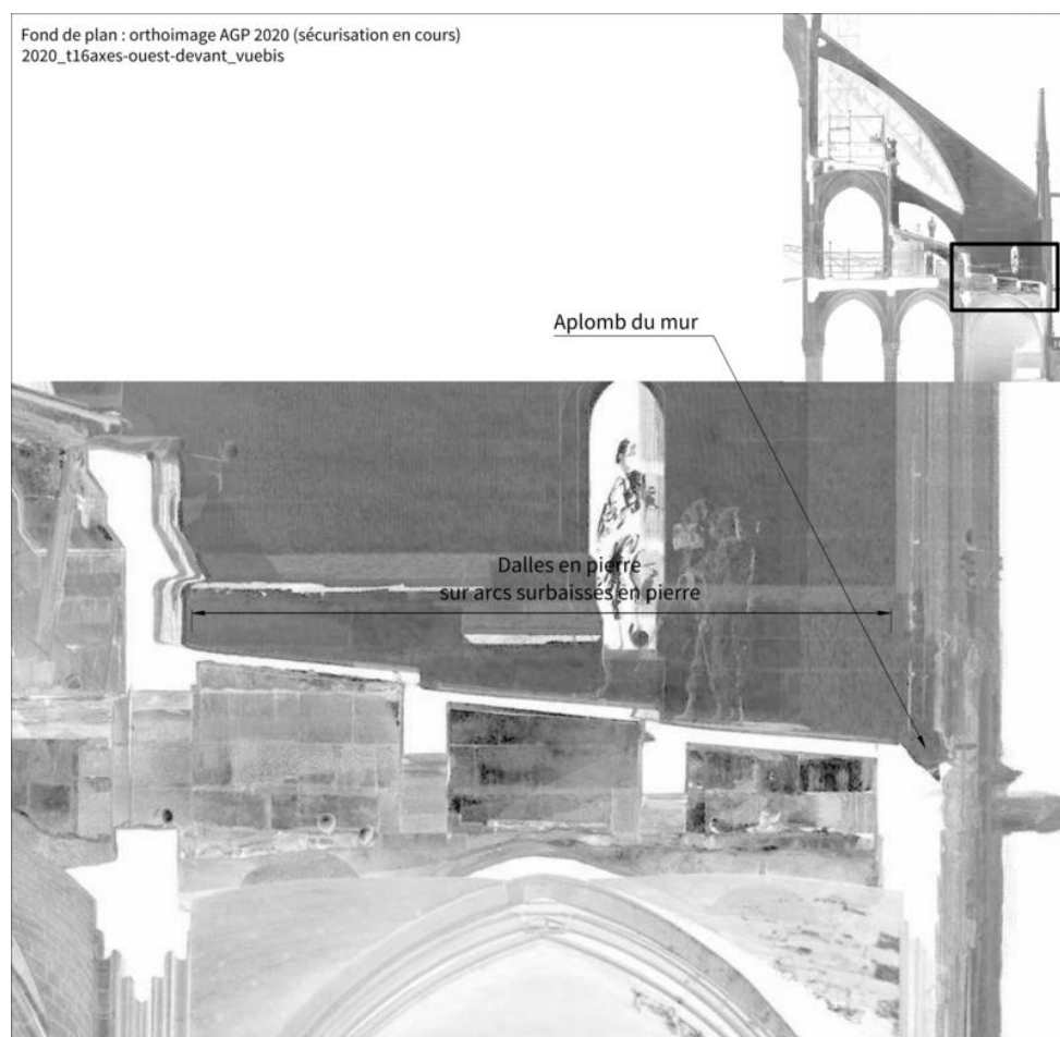
Figure 42 Vocabulaire pour les appuis au niveau de la terrasse basse à l'aplomb des chapelles
