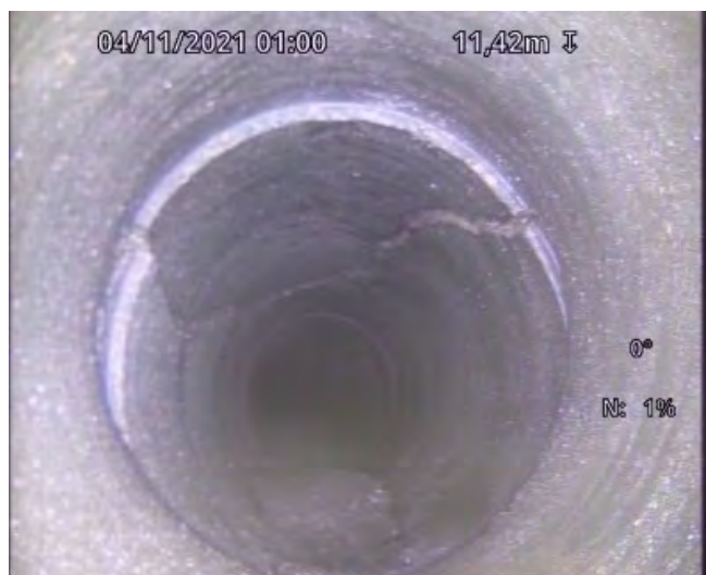
Photo img00614_004.jpg Position 11,42 m Vidéo 00:06:14 Code BAC Rupture/effondrement, Rupture , Longueur de la rupture / effondrement: 20mm, de 10 à 2 heure, dommages au niveau de l'assemblage des tuyaux, le dommage de la section nr. 1 commence ici, Dégradation structurelle du revêtement.
