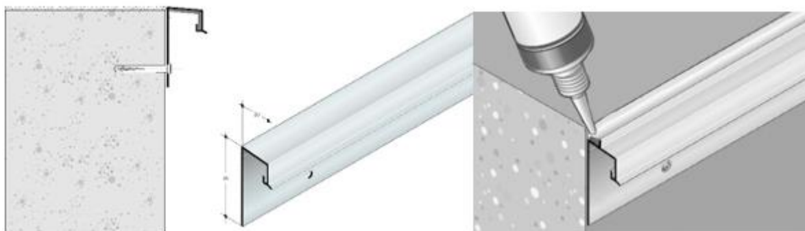
Figure 8 : principe de positionnement du larmier
