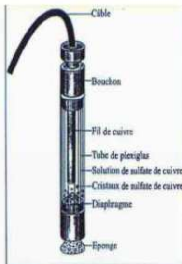
Fig. 2 Schéma de principe de l'électrode au cuivre/sulfate de cuivre
