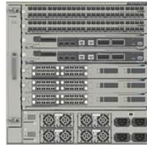
Exemple de cœur de réseau Cisco 6807-XL d'une hauteur de 10U déployé actuellement aux HCL.
