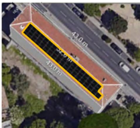
Projection d'une potentielle installation photovoltaïque sur le bâtiment D
