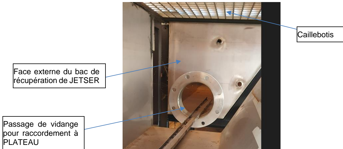
Figure 12 : bac de récupération + sortie de vidange du dispositif JETSER (passage DN200)
