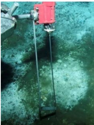
Figure 1. Sonde de gradient de température T-ROV (Ifremer) qui n'est plus disponible
