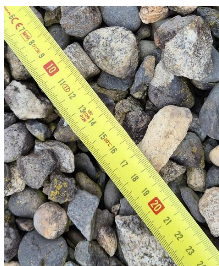
Fig. 36 – Vue de détail des gravillons 2ASud
