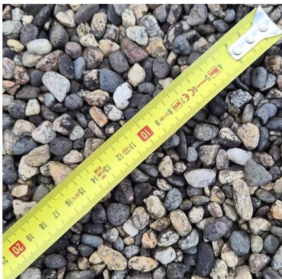
Fig. 39 – Illustration de la taille moyenne des gravillons 2ANord
