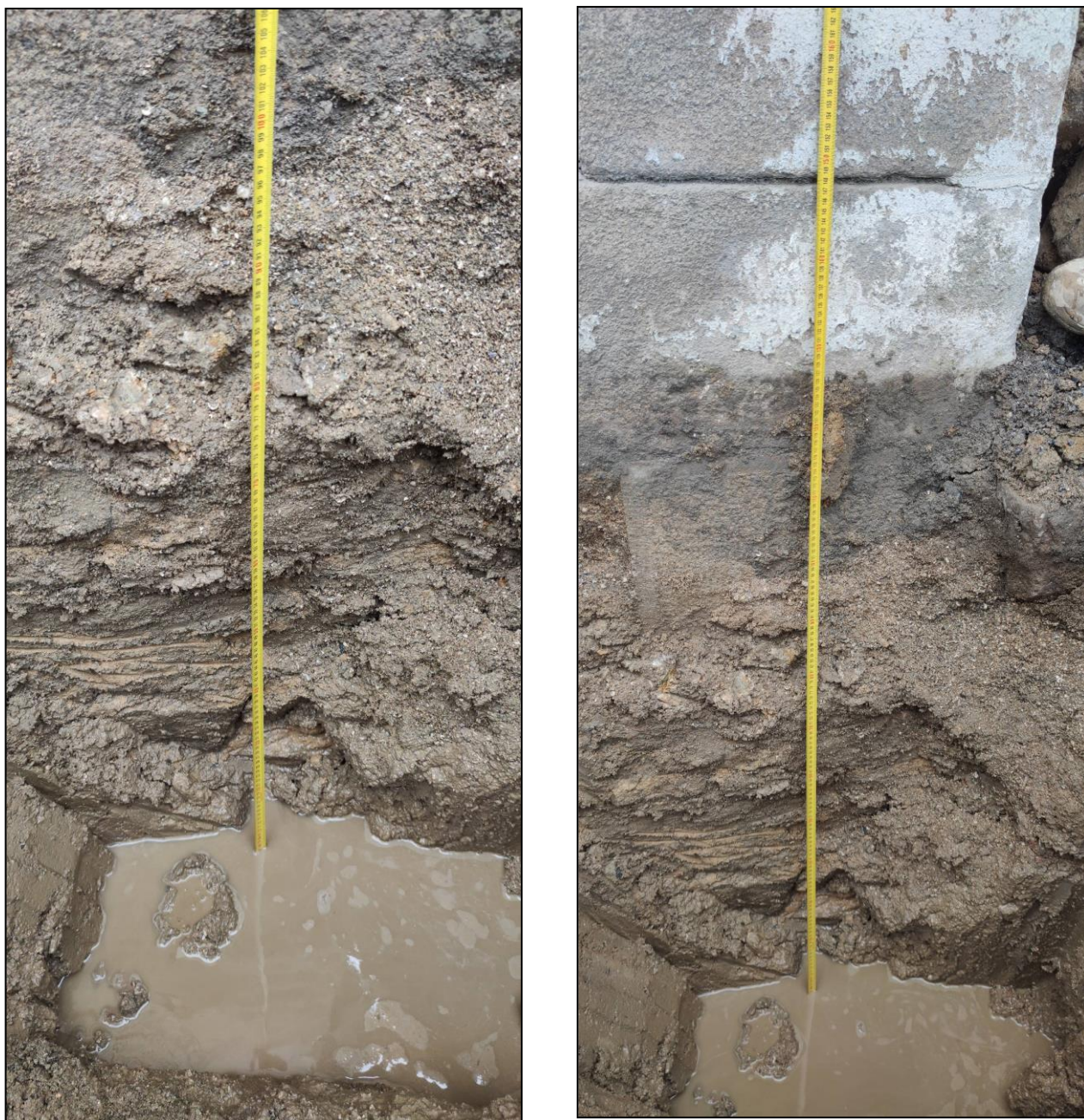
Figure 5 : Photographies de la reconnaissance de fondations RF2
