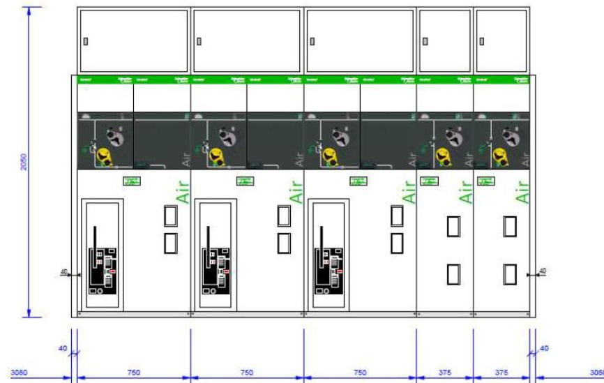
Principe Implantation Vue de Face (Gamme SM Air Set ou équivalent)
