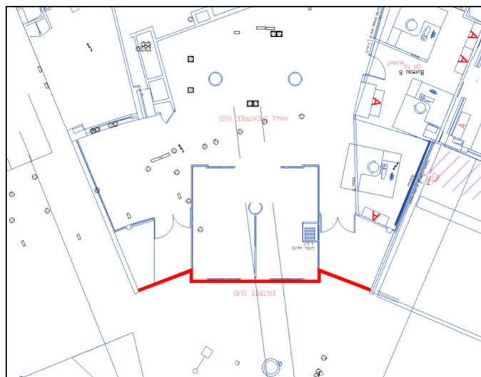
Limite de cloisonnement étanche à mettre en œuvre (trait rouge)
