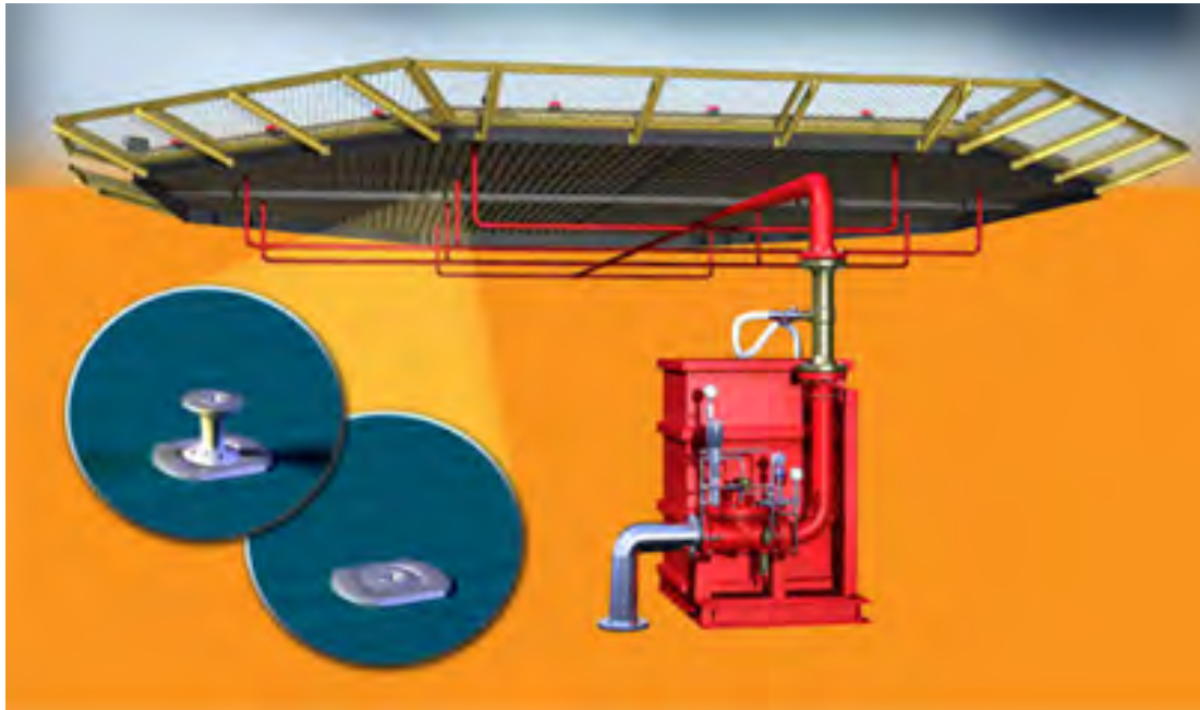
Schéma de principe d'un système d'extinction automatique à mousse par diffuseurs encastrés Source Aluminium offshore
