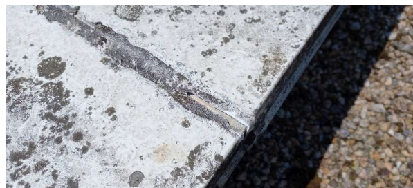
Prélèvement - P004 : Bâtiment MCO / Extérieur / Toiture - Revêtement d'étanchéité- (Absence d'amiante)
