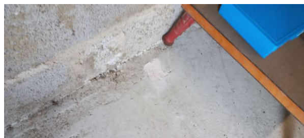
Prélèvement - P005 : Bâtiment MCO / Niveau 00 / Local cellules HTA - Sol coulé- (Absence d'amiante)
