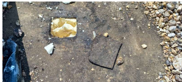
Prélèvement - P001 : Bâtiment MCO / Extérieur / Toiture - Revêtement d'étanchéité- (Absence d'amiante)
