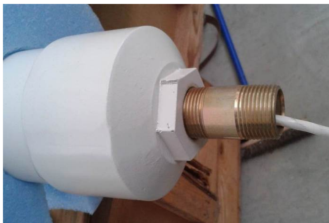
Montage de l'adaptateur du balisage avec produit d'étanchéité (pas conique 3/4" NPT)
