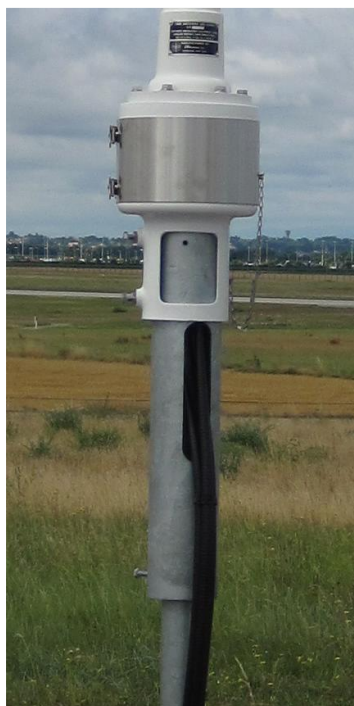
Les 2 pièces d'adaptation pour antenne DME
