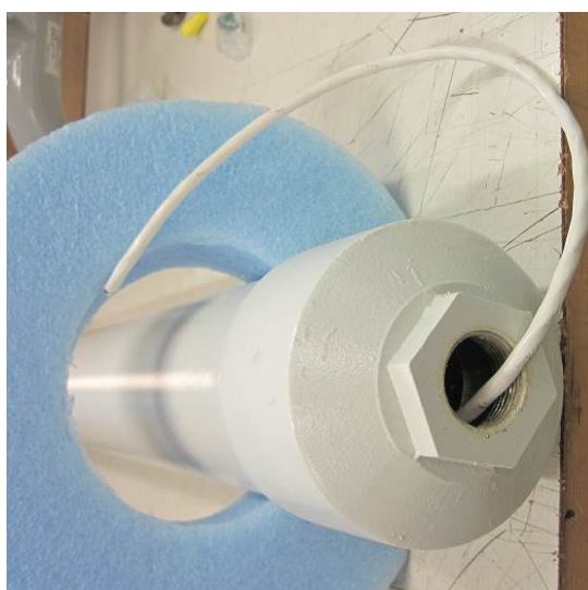
Sortie du câble 230V du balisage en haut de l’antenne
