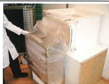
Poser le filtre usagé devant de caisson.
