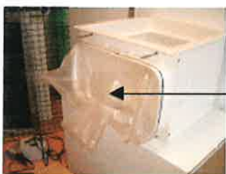
Réaliser deux autres cordons parallèles au-dessus du premier (environ 1cm entre les cordons)
