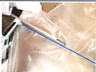
Réaliser un premier cordon de soudure au dessus du filtre pour fermer hermétiquement le sac.
