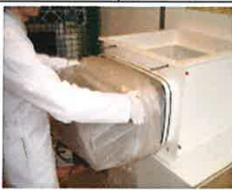
Faire glisser délicatement le filtre usagé dans le fond du sac.
